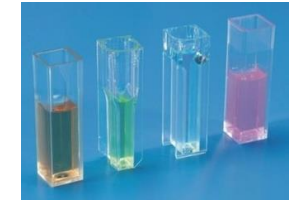
Figura 32.5 Exemplo de células para espectroscopia de ultravioleta-visível com amostras líquidas.
